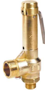
fig 904 messing veiligheidsklep 1/2" - 2" bsp MM huis : messing CW614N / met kleplicher viton-teflon of kalrez zitting temp. : -20°C/+200°C insteldruk : 0,5 - 15 bar (elke 0,5 bar) bijzonder geschikt voor stoom
