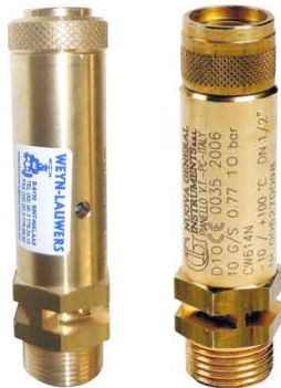
fig 906 messing veiligheidsklep 1/4" - 2" bsp / vrije uitlaat huis : messing CW614N viton zitting temp. : -10°C/+160°C insteldruk : 0,5 - 12 bar (elke 0,5 bar) bijzonder geschikt voor perslucht
