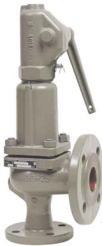
fig 1401 geflensd veiligheidsventiel PN16 DN20 tot DN150 huis : gietijzer GG20 / met kleplicher gesloten kap / RVS zitting temp. : -10°C +200°C min. afsteldruk 0,5 bar bureau veritas marine/offshore gekeurd
