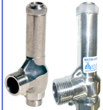
fig 905 RVS veiligheidsklep 3/8" - 2" bsp MM huis : RVS 316 teflon zitting temp. : -10°C/+200°C insteldruk : 0,5 - 12 bar (elke 0,5 bar)
