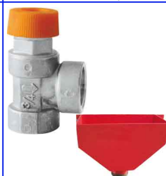
fig 911 messing veiligheidsklep 1/2" in - 3/4" uit bsp max. temp. : +110°C vooringesteld op : 3 of 6 bar zonne-verwarming installaties fig 915 : trechter in staal 250 x 100 mm 2" / 400 x 100 mm 2 1/2"
