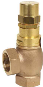
fig 901 bronzen overstortventiel 3/8" - 2" bsp huis : brons CC491K / gesloten kap teflon zitting max. druk : 20 bar / temp. : -40°C/+180°C insteldruk : 0,5 - 2,5 bar / 2,0 - 12 bar 12 - 20 bar
