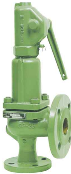
fig 1402 geflensd veiligheidsventiel PN40 DN20 tot DN150 huis : nod.gietijzer GGG40 / met kleplicher gesloten kap / RVS zitting temp. : -10°C +350°C min. afsteldruk 0,5 bar bureau veritas marine/offshore gekeurd
