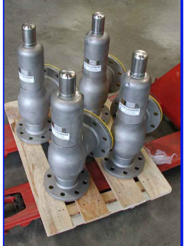
fig 905 RVS veiligheidsklep 3/8" - 2" bsp MM huis : RVS 316 teflon zitting temp. : -10°C/+200°C insteldruk : 0,5 - 12 bar (elke 0,5 bar)
