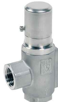
fig 902 RVS overstortventiel 3/8" - 5/4" bsp huis : RVS 316 (CF8M) / gesloten kap viton zitting max. druk : 30 bar / temp. : -10°C/+200°C insteldruk : 1,2 - 3,0 bar 2 - 12 bar
