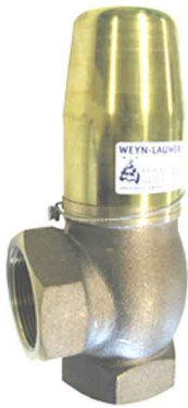
fig 900 bronzen veiligheidsklep 3/8" - 2" bsp huis : brons CC491K teflon zitting max. druk : 20 bar / temp. : -40°C/+180°C insteldruk : 0,5 - 2,5 bar / 2,0 - 12 bar 12 - 20 bar
