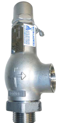
fig 1216 RVS veiligheidsklep 1/2" tot 2" bsp of npt huis : RVS A351 CF3M / gesloten kap viton- / teflon- of metaalachtende zitting druk : PN40 tot PN400 fig 1216C : met clamp-aansluiting fig 1216B : flenzen PN10/40 ansi 150/300 lbs
