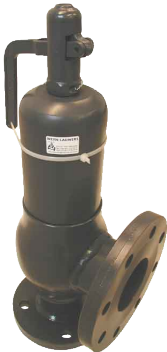
fig 1400 geflensd veiligheidsventiel DN15 tot DN500 huis : nod. gietzer/staal / open- of gesloten kap max. druk PN16 tot PN100 fig 1400S uitvoering in RVS fig 1415 flenzen ansi 150/300/600/900 lbs ansi 1500 / 2500 lbs
